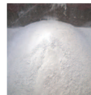
石膏ボード粉碎物
