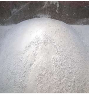
石膏ボード粉碎物
